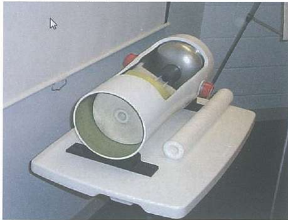
الشكل ٧١: قطاع عرضي في وعاء ضغط بداخله عنصر أغشية ملفوفة حلزونياً.
