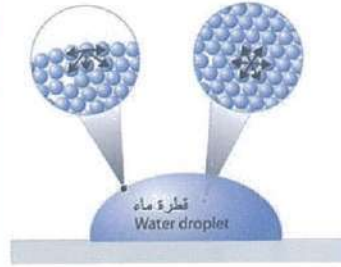
الشكل ٩: التوتر السطحي العالي للماء يجعل المقادير القليلة منه تميل لتشكيل قطرات كروية.
