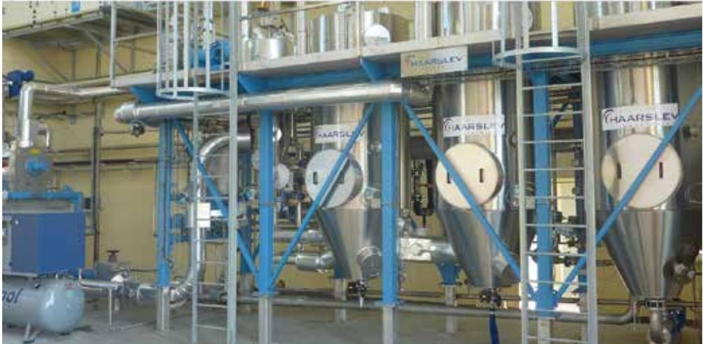
الشكل (2-1-1-2-5-2-2) صورة لجهاز التحلل الحراري للحمأة من شركة [Harslev Giotto, water co]
