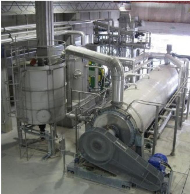
الشكل (2-3-1-4-1) صورة لجهاز تجفيف الحمأة (إيكو فلاش)
