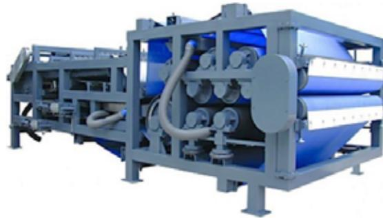
الشكل (1-2-1-6-2-2) مخطط وصورة لمراحل عمل فلتر الحزام الراشح الضاغط (المكبس المرشح بالحزام) [12], [Johnson screens]
